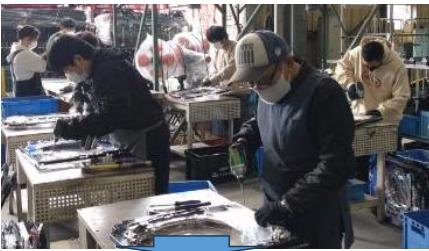
電動ドライバーを使い 分解・材質ごとに層別 作業
